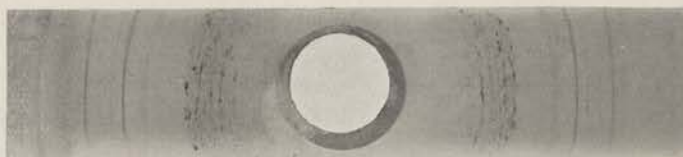
No. 2. Opname parawaterstof bij 1.7° K. Fe-straling ongefilterd.
