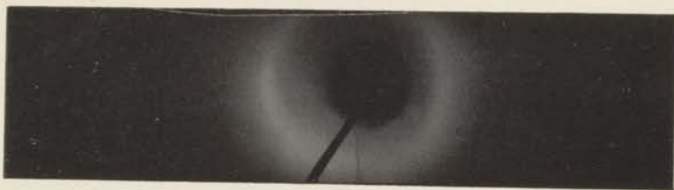
Opname I. He II; diameter straaltje 1,5 m.m.; dampdruk 6 m.m.
