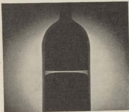
Fig. 9. Röntgenshaduwbeeld van een kwikmeniscus.
