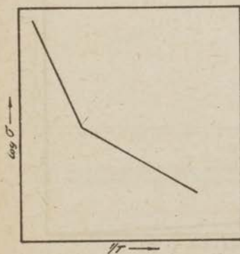
Fig. 10. Het electronengeleidingsvermogen van een halfgeleider met twee soorten stoorniveaux als functie van de temperatuur.
