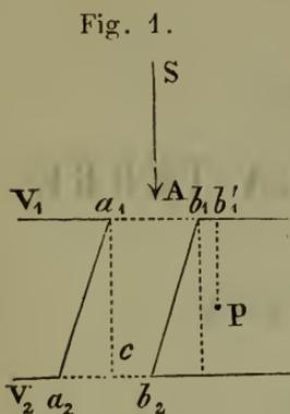
laquelle nous arrive le mouvement lumineux de l'étoile  $S$ ; perpendiculairement à cette direction plaçons un écran opaque  $V_1$ , percé d'une ouverture  $a_1 b_1$ . Nous supposons que cet écran soit entraîné par la terre dans son mouvement, que nous nous représenterons dirigé, dans la figure, de gauche à droite; ce mouvement n'affecte point l'éther environnant. Tous les points de l'ouverture
