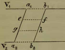
transmis à un certain moment par  $a_1 b_1$  se retrouve alors successivement dans les sections  $ef$ ,  $gh$ , etc. du cylindre oblique  $a_1 b_1 a_2 b_2$ . Ce cylindre détermine donc le mouvement relatif de la lumière par rapport à la terre; nous pouvons lui appliquer la dénomination de faisceau lumineux relatif,
