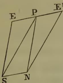
Ou bien : si cette dernière vitesse  $PS = B$  est composée avec une vitesse  $PE' = \kappa \varrho$  opposée à la direction dans laquelle se déplace l'éther, la résultante indiquera la direction de la normale de l'onde.
