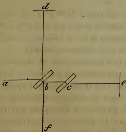
interférentiel de Jamin. Deux glaces de même épaisseur,  $b$  et  $c$  (fig. 19), étaient placées, parallèlement l'une à l'autre, dans une position verticale. Sur la première tombaient des rayons horizontaux  $ab$ , dont une partie était réfléchi à la face postérieure de la glace suivant  $bd$ , une autre partie étant transmise suivant  $bce$ . Le rayon réfléchi et le rayon
